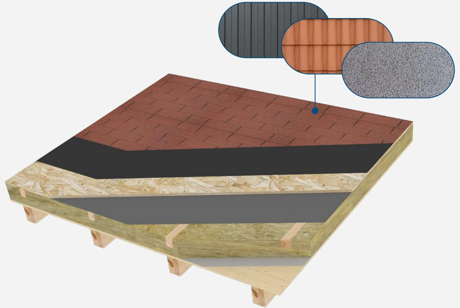
Le coperture delle nostre abitazioni sono caratterizzate da una struttura portante in legno lamellare con sovrapposto tavolato in abete e isolamento in lana minerale. Completano la fornitura barriera vapore, pannello OSB3, guaina e strato finale in diverse opzioni.
