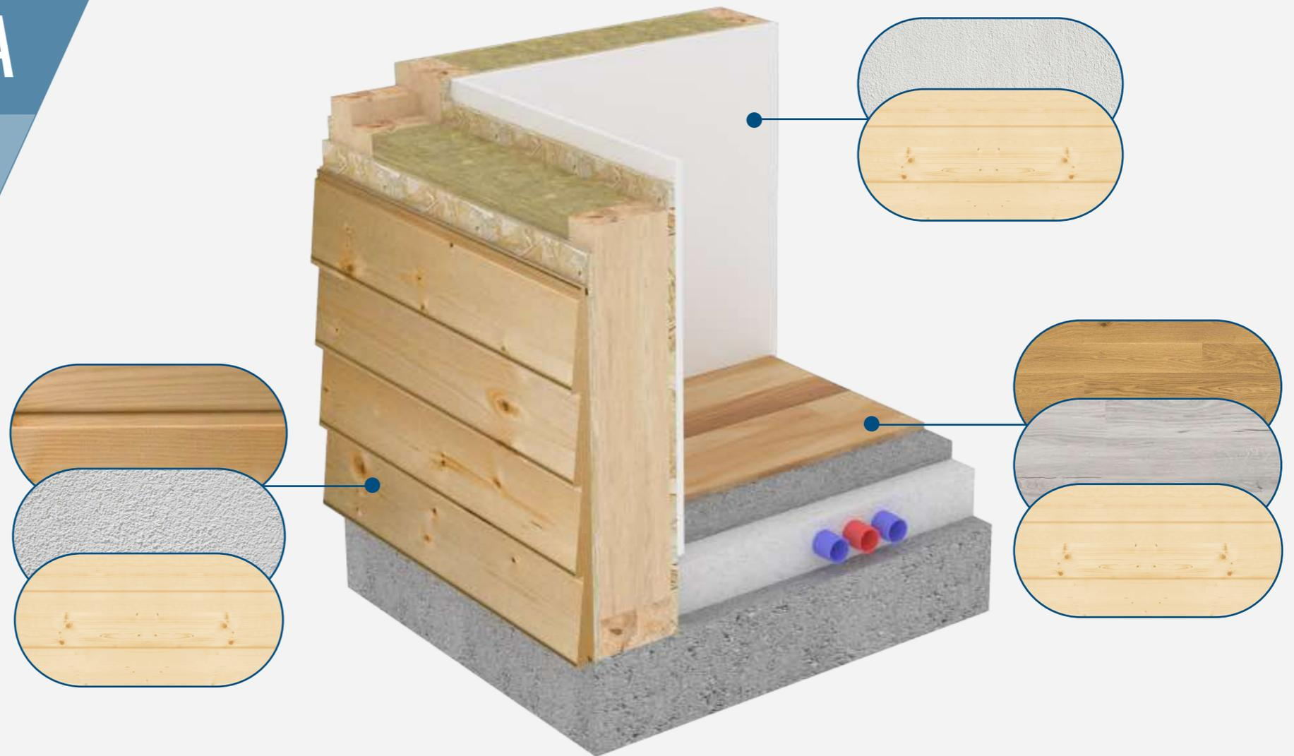
La parete esterna delle nostre abitazioni è caratterizzata da una struttura portante in legno lamellare controventata da pannelli OSB3 con interposto isolamento termico in lana minerale. Finiture interne ed esterne sono personalizzabili a seconda delle esigenze.
